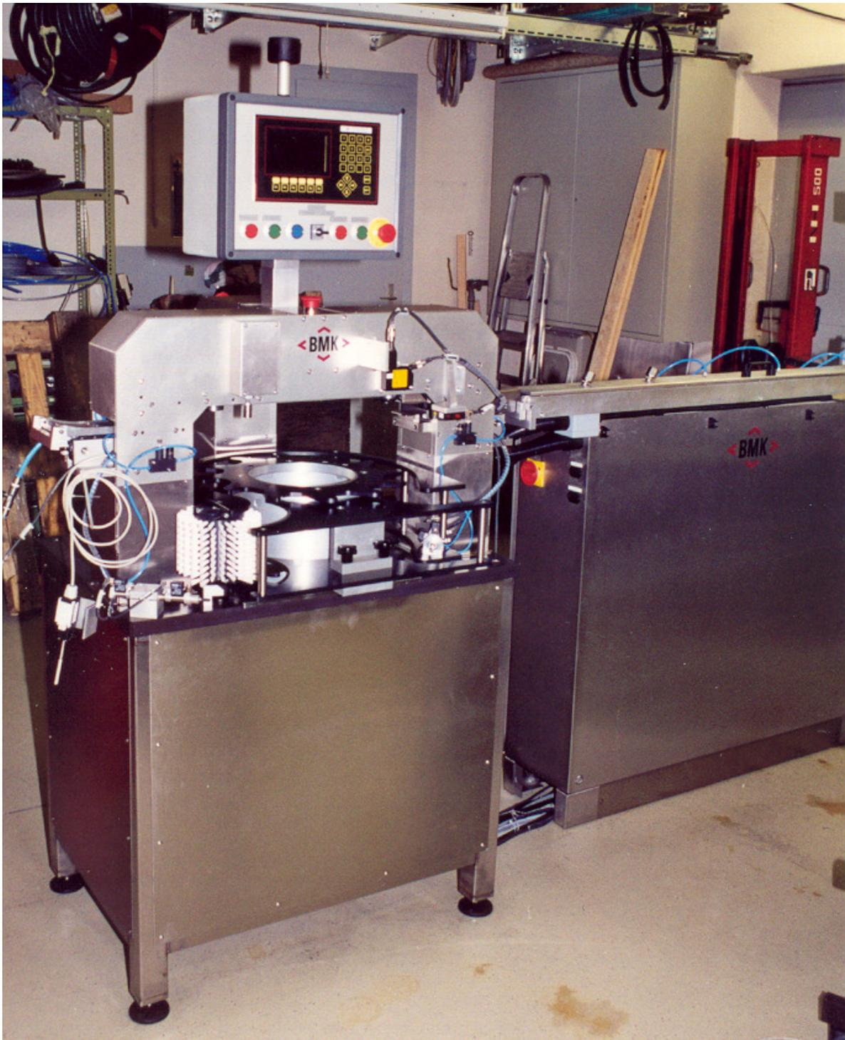
**Ringaufsetzer für Spraydosen**
