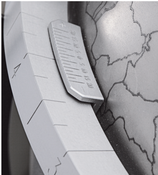
Mit Hilfe der Korrektur-Skala lässt sich die Abweichung der Sonnenlaufbahn einstellen.
