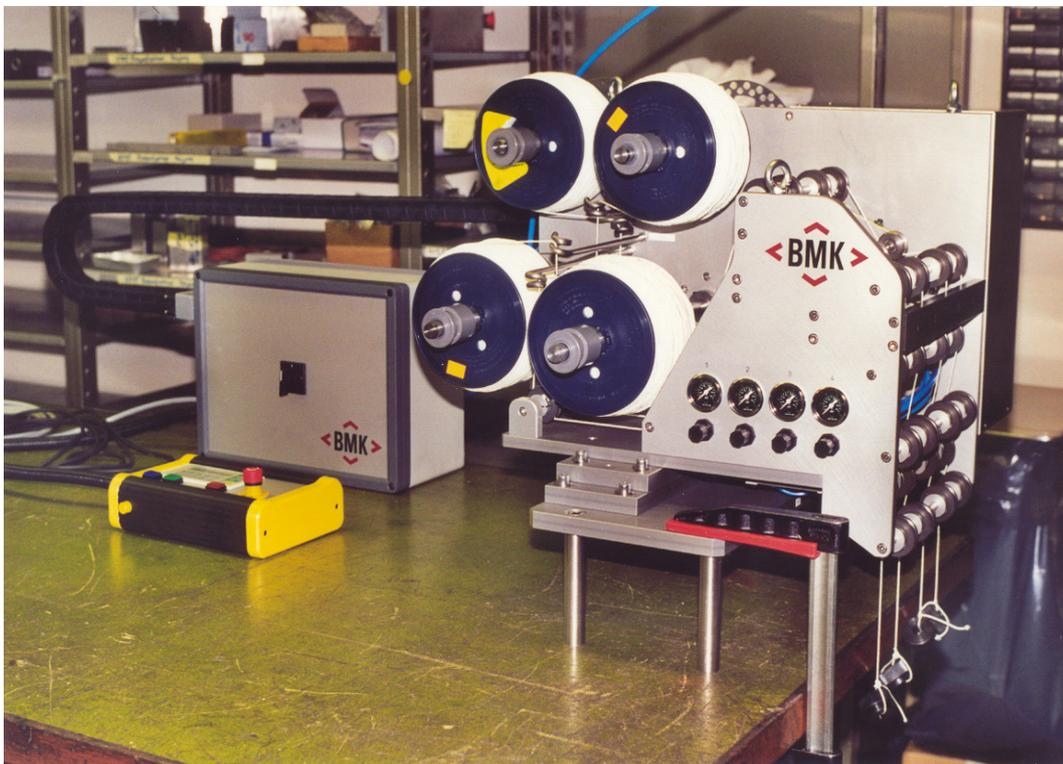
**Abrolleinheit für 4-fach Kordel in Spritzmaschine**
